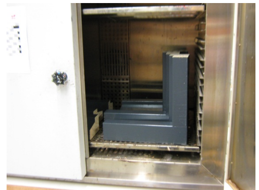
Foto 2; kozijnhoeken verwarmen in een oven
